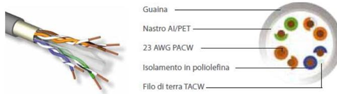
Per la soluzione non schermata Cat. 6A Cavo U/UTP 4 coppie 23AWG 10GPlus HF1 LSZH (codice **AC6U-HF1-500VT**)
